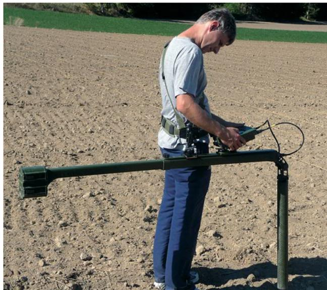
Abb. 2: Messung mit 3-Achsen-Fluxgate-Gradiometer (DIMADS).
