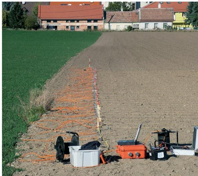
Abb. 4: Auslage für Electrical Resistivity Tomography in der Südfläche (Westprofil).
