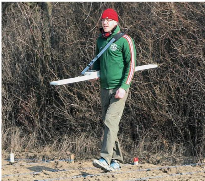
Abb. 1: Messung mit elektromagnetischem Sensor (GEM-2 Broadband EMI).
