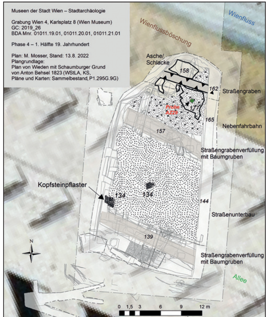
Abb. 17: Phase 4 – Straße mit teilweise erhaltenem Kopfsteinpflaster, flankierenden Grabenverfüllungen mit Baumgruben und Nebenfahrbahn. (Plan: M. Mosser)
